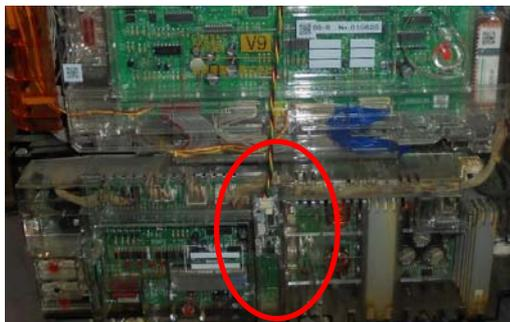
渡り配線が上方向になるように設置して下さい。
