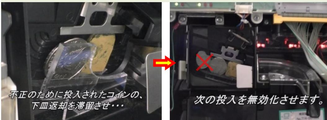
対策効果②・・・不正器具の回収をする為に、返却ボタンやセル等の器具を使用し不正器具をキャンセルシュートに落下させます。その落下させた不正器具を受け止め、下皿に返却させない構造になっております。
