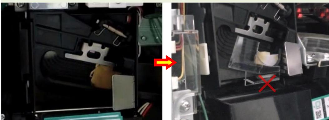
不正器具を使用されていない場合、リプレイ時やクレジット満タン時にメダルが下皿に返却される構造になっております。※設置時に必ず、数十枚の投入テストを実施して下皿に返却される事を確認してください。正しい設置位置で無い場合、メダルが当該対策品に引っかかる可能性があります。
