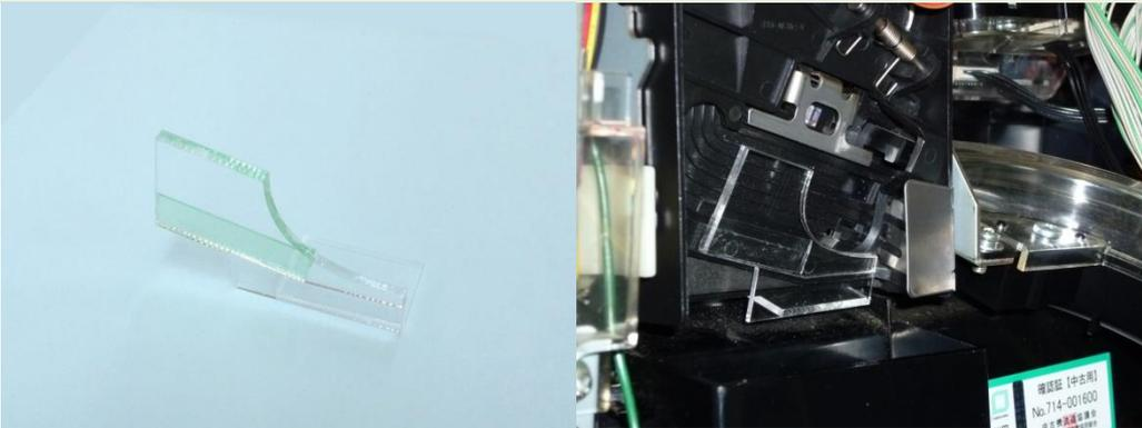
対策効果①・・・風車式クレマンを使用する為には、メダルの投入が不可欠です。投入されたメダルは、セレクターソレノイドの作動で手前に倒れ、キャンセルシュート内を通過し下皿に返却されます。その手前に倒れるメダルを滞留させ、次のメダル投入を無効化させます。
