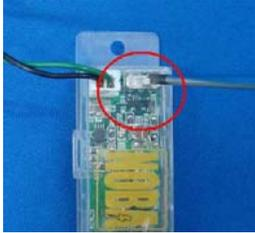
ナンバーランプの不正入力と「NOBA Type S」を接続します。正常に接続している場合は本体上のLEDが点灯します。薄暗く点灯する場合も正常ですのでよく確認して下さい。
