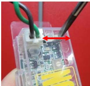
①LEDの点灯確認後は左写真のようにスライドスイッチを逆方向へ移動させて下さい。
