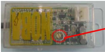
写真の方向に見て、ボリュームを若干（5分位）右に回して下さい。（小さめのマイナスインドライバーを使用します。）
